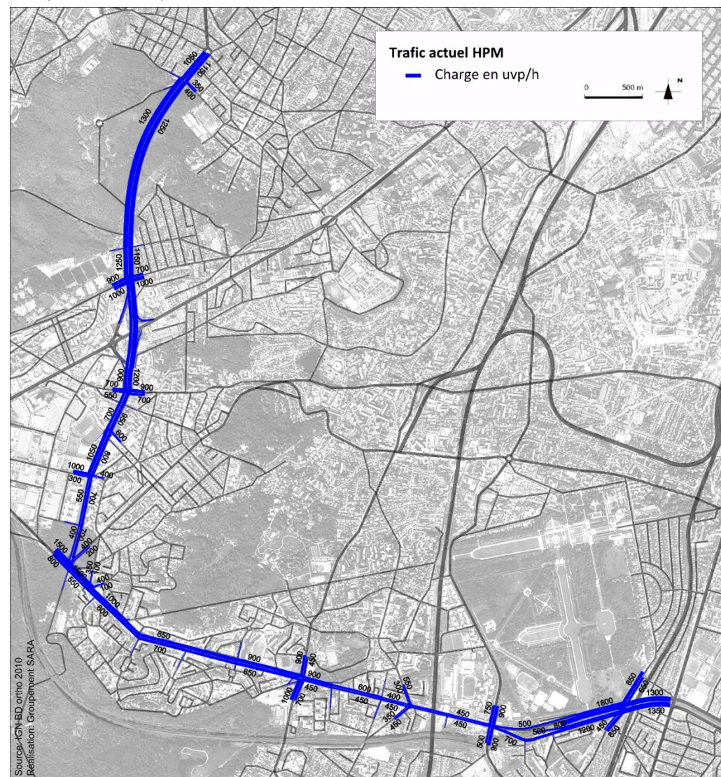
Illustration 167. Charges de trafic actuelles à l'heure de pointe du matin, source : Département Hauts-de-Seine
